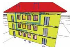
Die neue Lüftungstechnik: Zu- und Abluftleitungen werden an der Fassade geführt. Somit werden nur zwei Kernbohrungen/ Wohnung benötigt.
